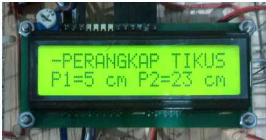
Gambar IV.13 Hasil Pembacaan Sensor Ultrasonik pada LCD
