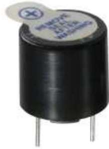
Gambar II.7 Bentuk Fisik Buzzer
