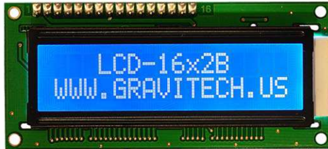
Gambar II.6 Bentuk Fisik LCD 16x2
