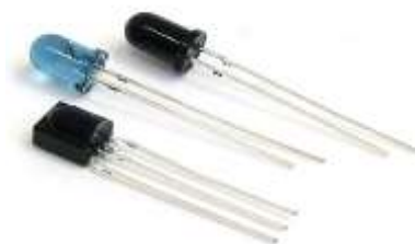
Gambar II.6. Bentuk Fisik LED Infrared
