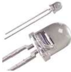
Gambar II.7. Bentuk Fisik Photodiode
