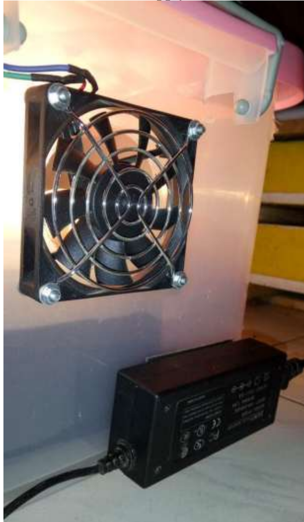
Gambar IV.5. Peletakan Kipas dan Power Supply
