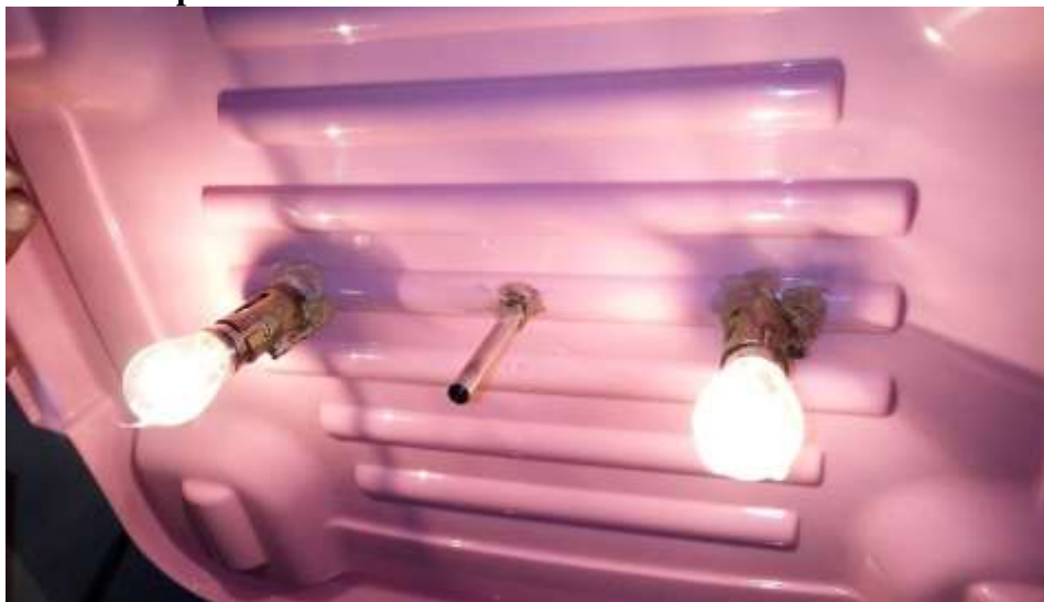
Gambar IV.4. Peletakan Lampu dan Sensor
