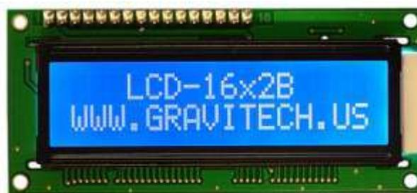
**Gambar II.7 Bentuk Fisik LCD 16x2**
