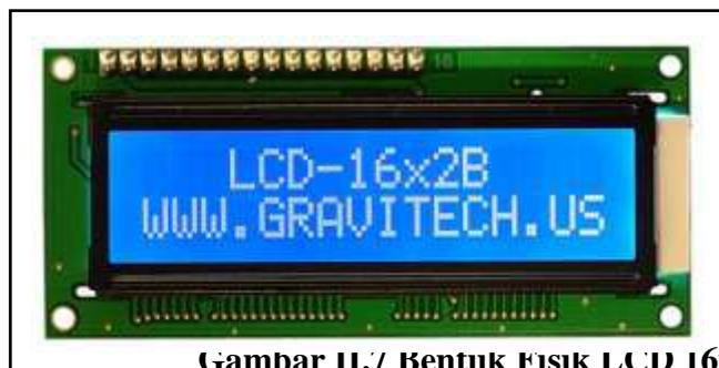
**Gambar II.7 Bentuk Fisik LCD 16x2**
