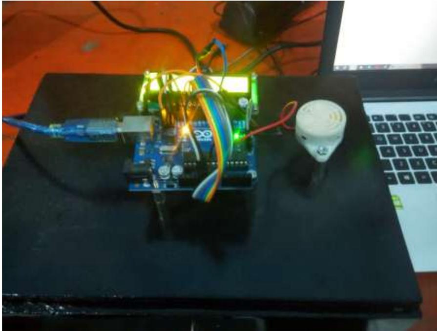
**Gambar IV.17 Alat Pendeteksi Uang Palsu Tampak Atas**
