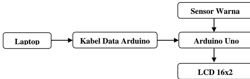
**Gambar IV.10 Blok Diagram Pengujian Sensor Warna**
