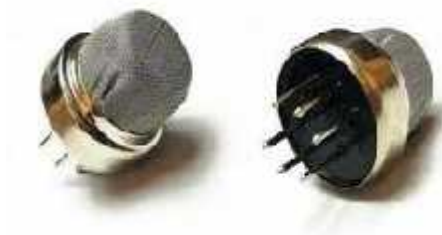
Gambar II.4. Bentuk Fisik MQ2 Sumber : Datasheet MQ2
