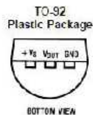
Gambar II.2. Bentuk LM35 Tampak Bawah Sumber : Datasheet LM35
