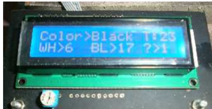
Gambar IV.22. Tampilan LCD Mendeteksi Objek Hitam
