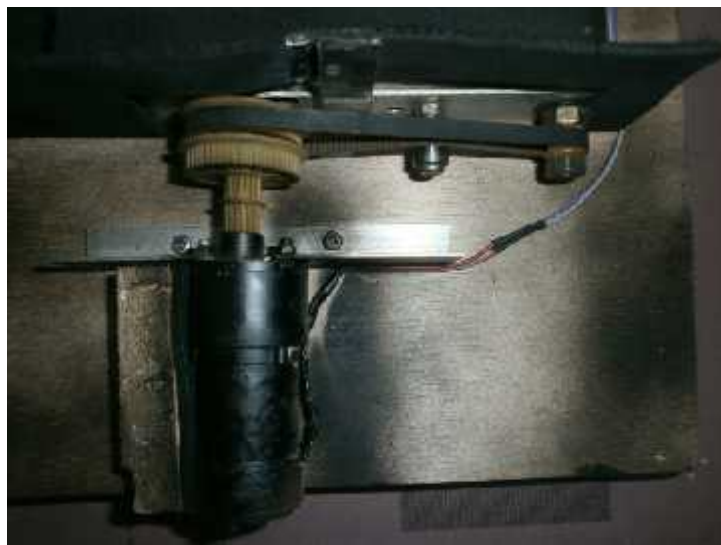
Gambar IV.17. Motor DC penggerak konveyor
