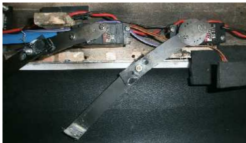
Gambar IV.16. Motor Servo Pemisah Barang
