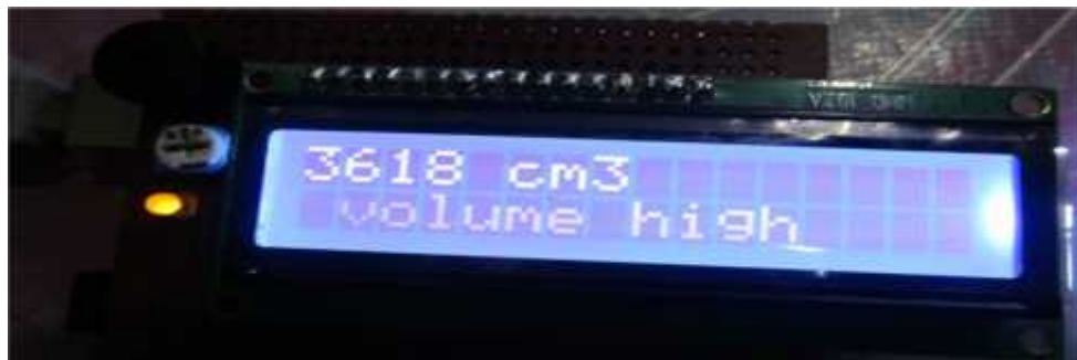
Gambar IV.26. Pengukuran Volume Residu dengan Nilai High pada LCD 16x2
