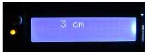
Gambar IV.16. Hasil Pengujian Ketinggian 3 cm pada LCD
