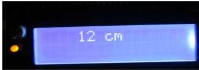
Gambar IV.18. Hasil Pengujian Ketinggian 12 cm pada LCD
