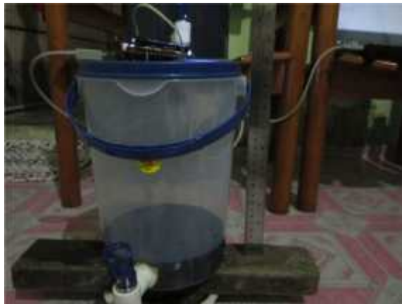
Gambar IV.11. Peletakan Penggaris sejajar dengan Prototipe Tangki
