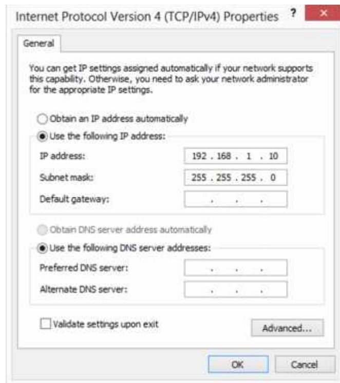
Gambar III.10. Pemberian IP Address Pada Interface LAN Laptop
