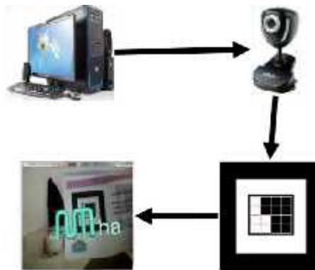
Gambar II.2. Ilustrasi Arsitektur Perangkat Augmented Reality
