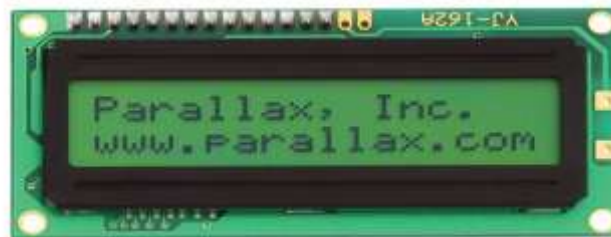
Gambar II.7 Komponen LCD 2x16 Karakter
