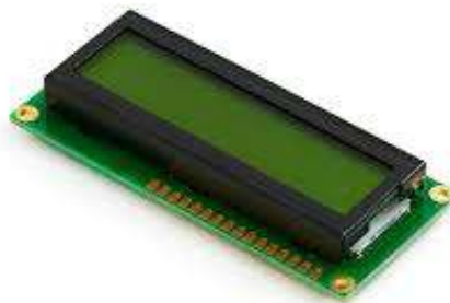
Gambar II.4. Bentuk Fisik LCD 16x2 (Sumber : 20 Aplikasi mikrokontroler Atmega8535 & ATmega16 menggunakan Bascom-AVR, Afrie Setiawan)
