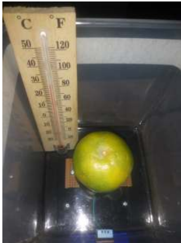
Gambar IV.16. Pengujian Sensor Kelembaban dan Suhu DHT11 Dengan Thermometer Analog
