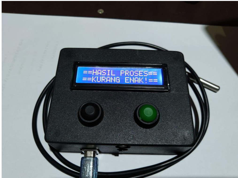
Gambar IV.15 Foto Proses Pengujian Suhu Pada Coffee Dengan Logika Fuzzy
