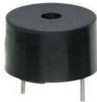
Gambar : II.6. Bentuk Fisik Buzzer (Sumber : Prihono, dkk.,2009)
