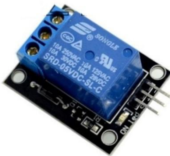
Gambar : II.7. Bentuk Fisik Relai (Sumber :Eko Saputro,2016)
