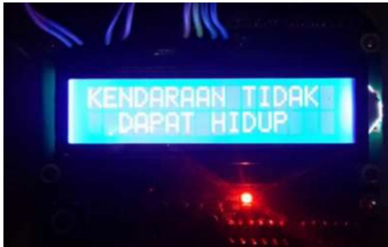
Gambar IV.18. Tampilan LCD Saat Kendaraan Tidak Dapat Hidup
