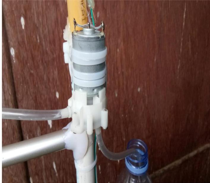
**Gambar IV.7. Pompa Air Menggunakan Tegangan 9 VDC**
