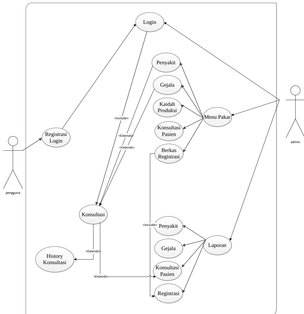
Gambar III.3. Use Case Diagram Sistem Pakar Diagnosa Penyakit Liver Dengan Metode Certainty Factor
