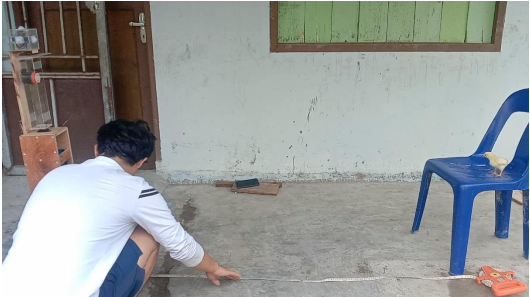
Gambar IV.20. Pengukuran jarak deteksi sensor PIR
