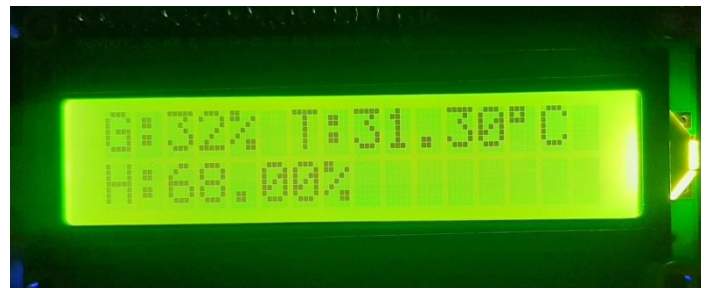
Gambar IV.13. Tampilan Perangkat LCD 16x2 Ketika Kadar Gas Diatas 25%
