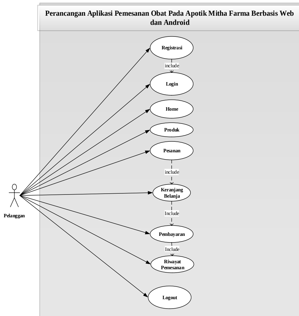
Gambar III.2. Use Case Diagram Perancangan Aplikasi Pemesanan Obat Pada Apotik Mitha Farma Berbasis Web dan Android
