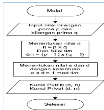
Gambar II.2 Flowchart Proses Pembangkitan Kunci Algoritma RSA
