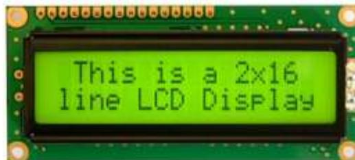
**Gambar II.5. Bentuk Fisik LCD 16x2**
