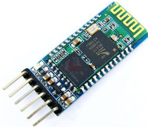
**Gambar II.4 Bentuk Fisik Modul Bluetooth HC-06**
