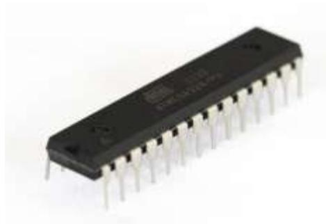
**Gambar II.1. Mikrokontroler ATmega328**
