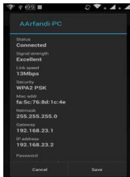
Gambar IV.11 Tampilan Konfigurasi IP Address Pada Pelanggan
