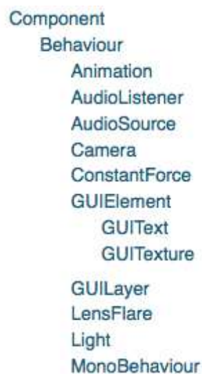
Gambar II.4. Hierarki class dari sebuah component yang berisi behaviour (Sumber: Philip Chu; 2009: 8)
